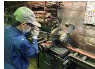
図5 鋼材の切り出し作業
