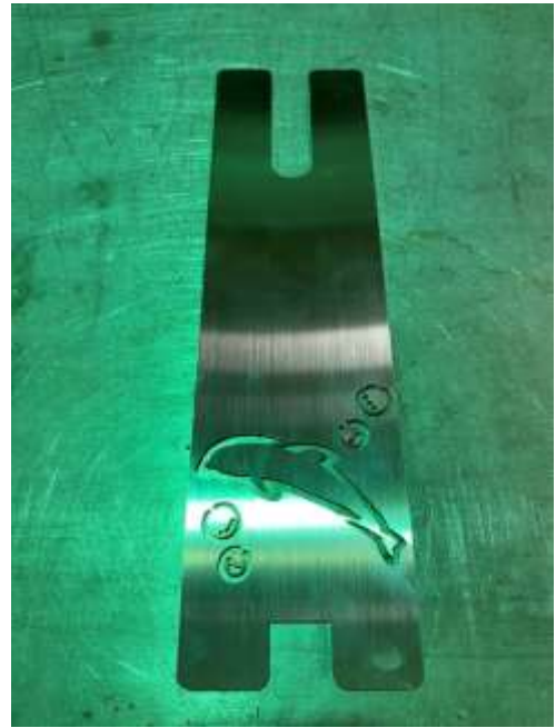
図2 レーザー加工後の板金
